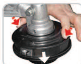
Apertura veloce della testina per manutenzione e pulizia.
